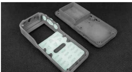
Maciej Burzynski, de Sybet, ha creado un prototipo con Sinterit Lisa de un receptor portátil para KGHM, líder mundial en la producción de cobre y plata. La impresión de todo el conjunto de piezas del radioteléfono con PA12 y Flexa Grey cuesta menos de 600 dólares y tarda unos cuatro días en realizarse.
